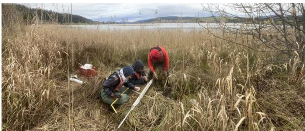
Photo 5: carottage et relevé stratigraphique au bord de la tourbière du Crossat, novembre 2024 (© V. Bichet)
